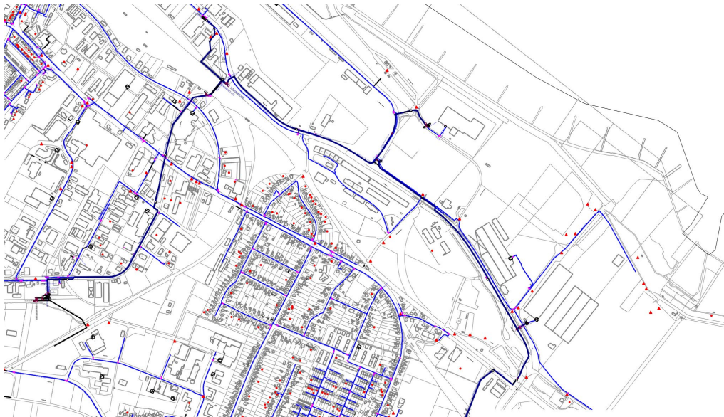
Abbildung 13: Ausschnitt lokales Gasversorgungsnetz (E.W.E. AG 2022)
