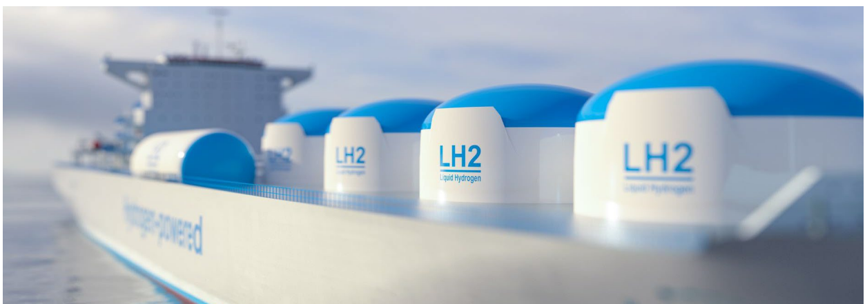
Abbildung 5: Schiffstransport von flüssigem Wasserstoff mit Komposit-Kryotanks ©AA+W/stock.adobe.com
